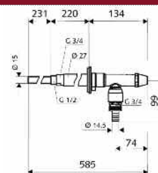
03 998 03 99 SCHELL Polar II grifo para exteriores resistente a las heladas.
